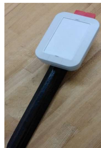
法面監視用杭に装着
